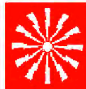
PULSANTE DI ALLARME ANTINCENDIO
